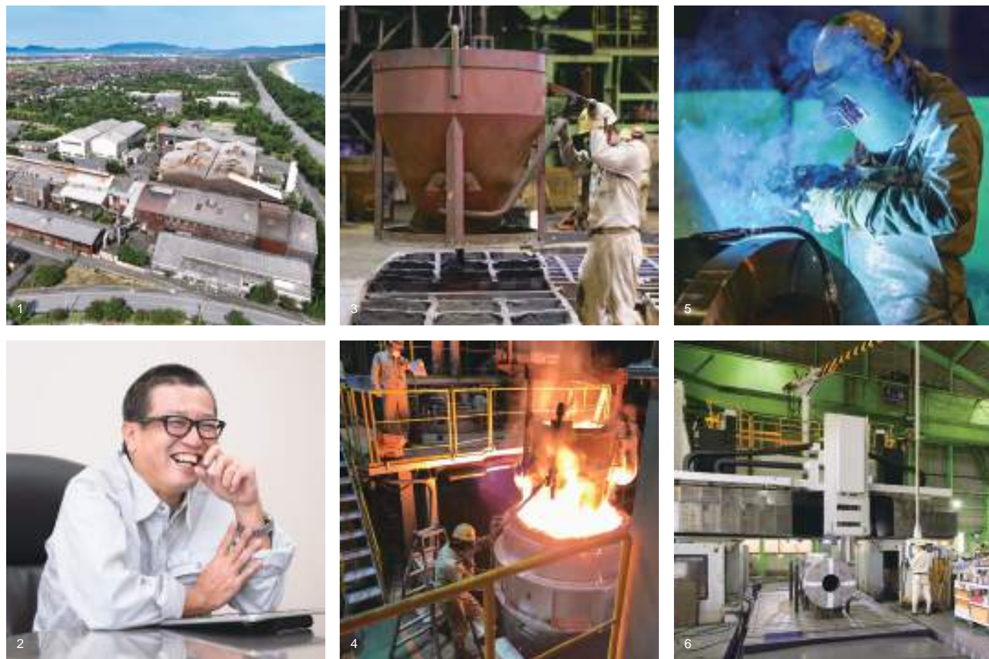
1 美保湾に近い72,600㎡の敷地に、鋳鋼工場、機械加工工場などが配置された本社工場 2 2023年3月に就任した井上昭彦社長 3 製作した木型をセットした金枠に砂を詰め「鋳型」を作る 4 溶かした鋼を鋳型に流し込む「鋳込み」工程 5 機械加工後の製品の溶接作業 6 複雑形状の製品の機械加工に対応する同時5軸門型MC
