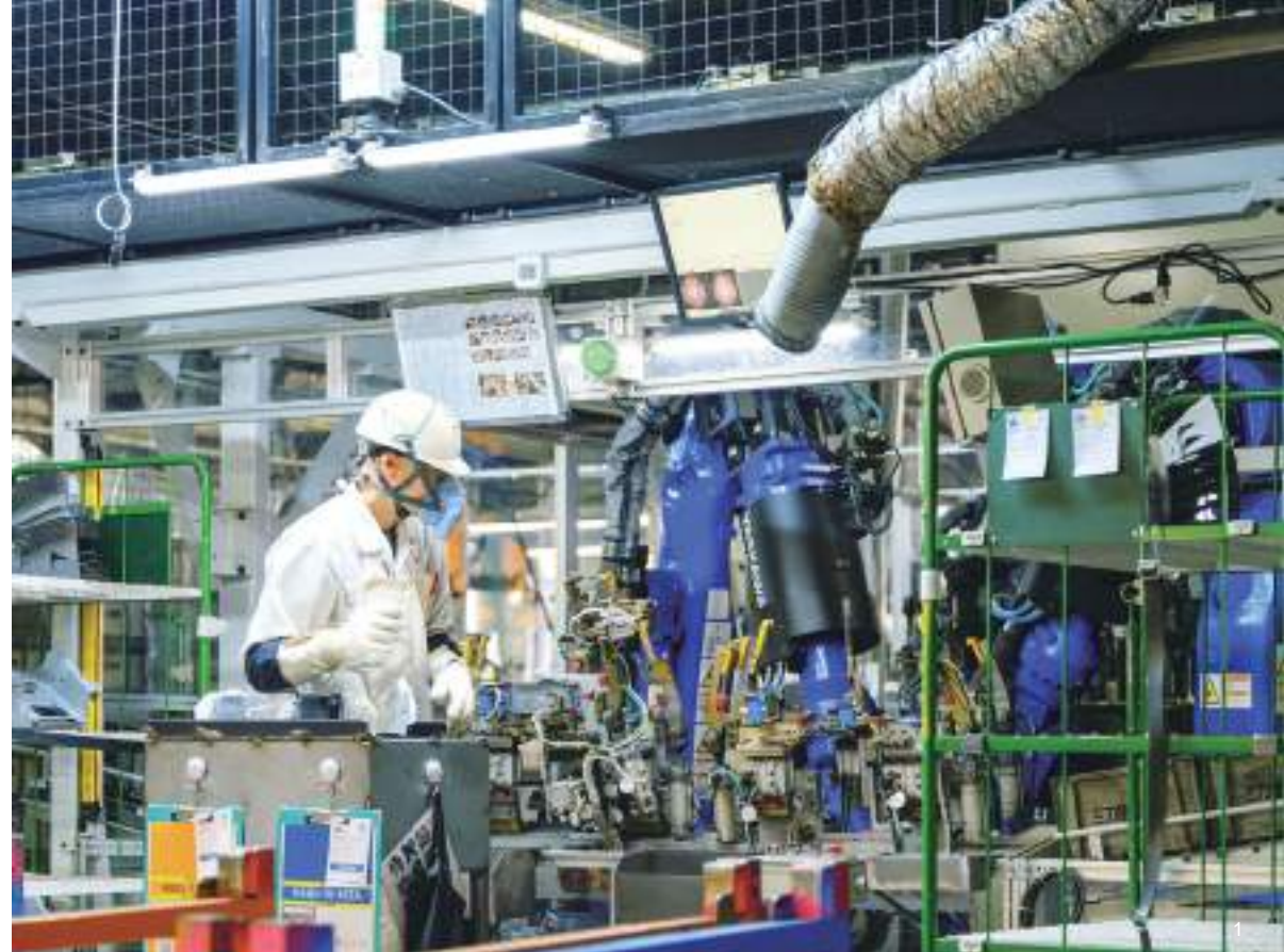
1 中小物のプレス品はロボットを活用した自動ラインで溶接を行い、骨格となる重要な部品を生産する 2 2022年から代表取締役を務める久留主社長。キーレックスのプレス技術領域に長年携わっていた 3 敷地内に設けられている「技能実践道場」。従業員の技術を磨くシステムが整えられている 4 お昼休みのひととき。女性社員も多い
